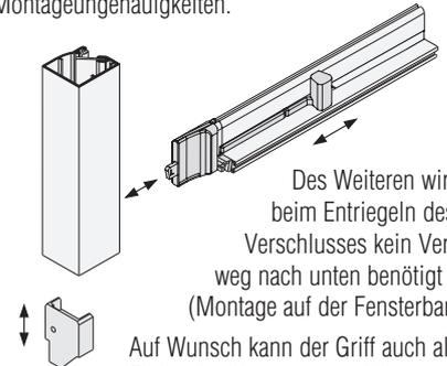
Des Weiteren wird beim Entriegeln des Verschlusses kein Verfahrweg nach unten benötigt (Montage auf der Fensterbank).
