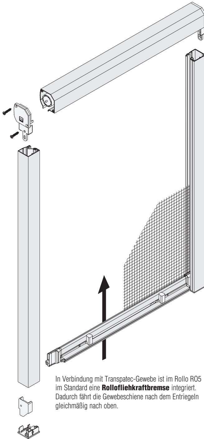
In Verbindung mit Transpatec-Gewebe ist im Rollo R05 im Standard eine **Rollofliehkraftbremse** integriert. Dadurch fährt die Gewebeschiene nach dem Entriegeln gleichmäßig nach oben.
