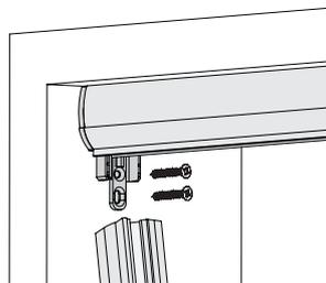
So kann z.B. das Rollo problemlos zwischen Fenster und Rollladeführungsschiene montiert werden (Platzbedarf 40 mm).
